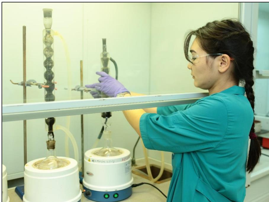
Рисунок 10 – Синтез ТПФН для композиционного состава ингибитора солеотложений
